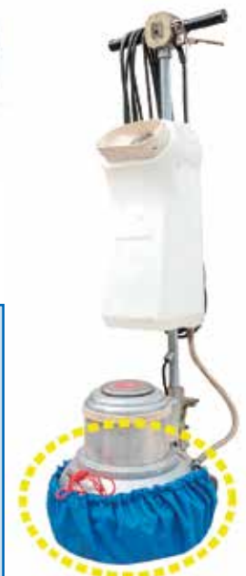
全体が締まったのを確認し付属の金具をとめて完成。
