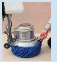
全体が締まったのを確認し付属の金具をとめて完成。
